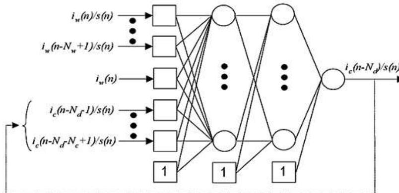
Рис. 7. Структура ИНС для коррекции ТТ
