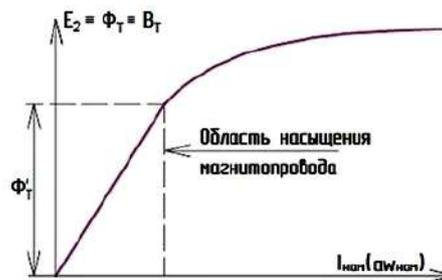
Рис. 1. Характеристика намагничивания трансформатора тока
