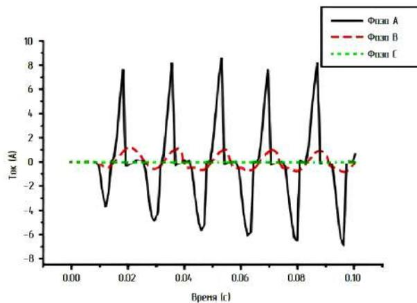
Рис. 5. Ток ТТ с насыщением при внутреннем повреждении силового трансформатора
