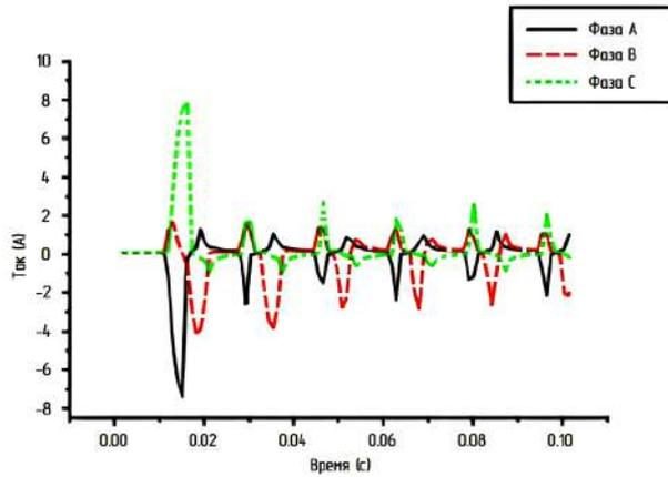
Рис. 3. Пусковой ток ТТ с насыщением
