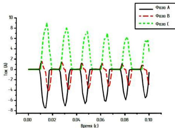
Рис. 2. Пусковой ток идеального ТТ
