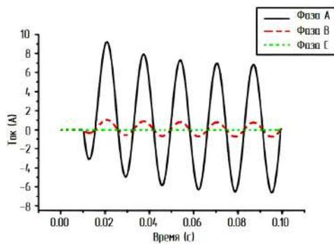
Рис. 4. Ток идеального ТТ при внутреннем повреждении силового трансформатора
