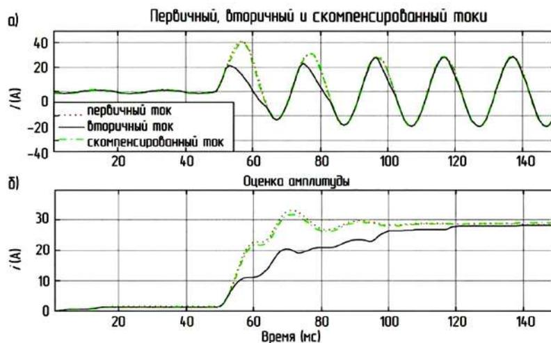
Рис. 8. График токов фазы В, полученных при моделировании 3-фазного замыкания на подстанции ( $R = 0$  Ом). Компенсация, осуществляемая ИНС структуры 5-5-1 (а). Оценка амплитуды первичного, вторичного и компенсированного тока (б)
