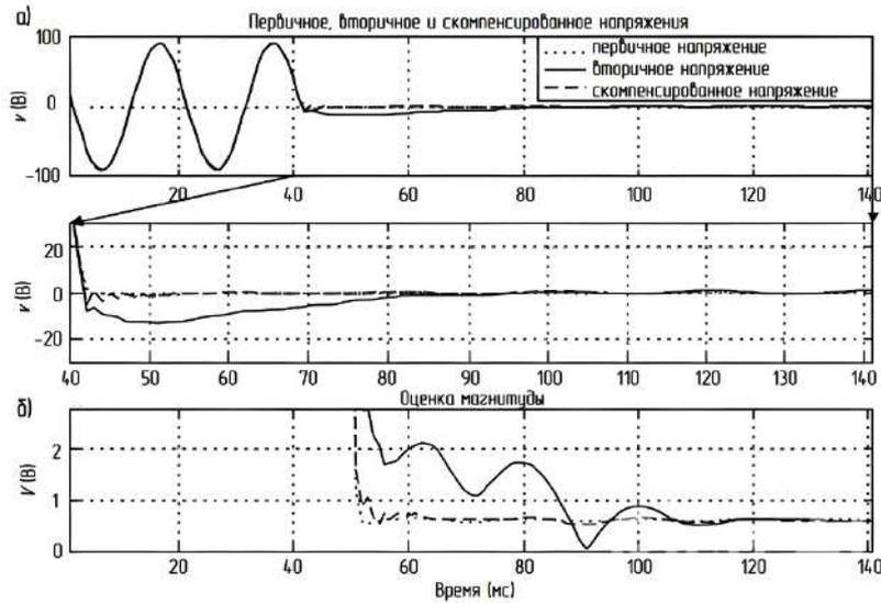
Рис. 9. Результаты компенсации ошибок переходных процессов ТН при замыкании на землю на подстанции. Компенсация, осуществляемая ИНС структуры 5-5-1 (а); оценка амплитуды первичного, вторичного и скомпенсированного напряжения (б)
