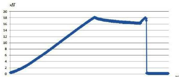
Рис. 5. Диаграмма нагружения образца, заполненного по всему объему
