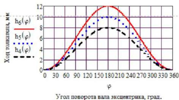
Рис. 6. Графики хода толкателя для вала с эксцентриситетами 6 мм, 5 мм и 4 мм
