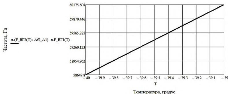
Рис. 13. Изменение разностной частоты (при использовании *десятих* гармоник частоты сигналов ВГ1 и ВГ2) в диапазоне температур от минус 40 °С до минус 39 °С
