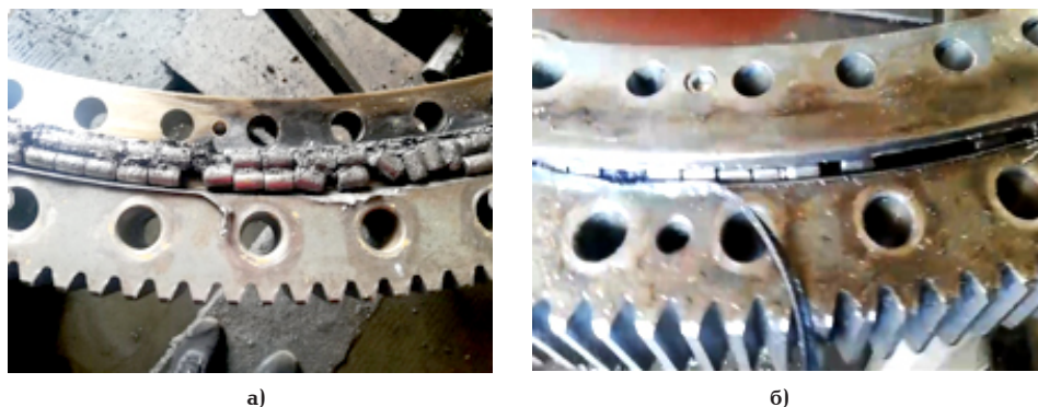
Рис. 1. Характерные отказы ОПУ: а — выпадение тел качения из кассет (сепараторов); б — выдавливание уплотнительной ленты
