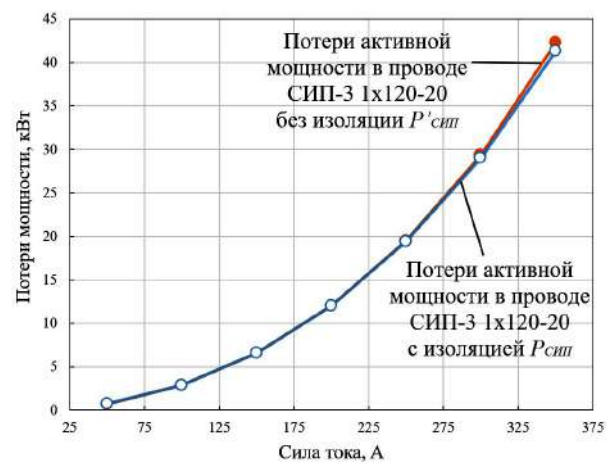
Рис. 8. Потери активной мощности СИП-3 1x120-20 с изоляцией P_{СИП} и СИП-3 1x120-20 со снятой изоляцией P'_{СИП} при вариации силы тока
