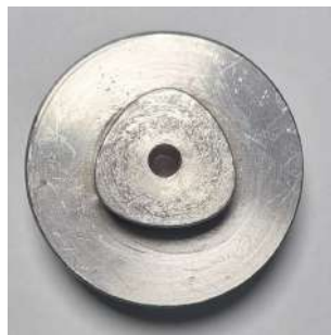
Рис. 2. РК-3 профильное соединение и схема нагружения втулки
