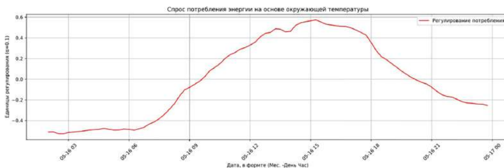
Рис. 4. График реакции спроса на электроэнергию в зависимости от температуры окружающей среды
