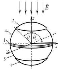
Рис. 4. Сферический однокоординатный датчик напряженности электрического поля сдвоенного типа
