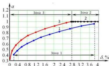
**Рис. 7. Результаты сравнения сдвоенного и двойного датчиков и зоны их использования: зона 1 — двойной датчик с  $57^\circ < \theta_1 < 62^\circ$ ; зона 2 — сдвоенный датчик с  $46,38^\circ < \theta_1 < 52,25^\circ$  и  $62,5^\circ < \theta_2 < 90^\circ$ ; зона 3 — сдвоенный датчик с  $46,5^\circ < \theta_1 < 50,5^\circ$  и  $\theta_2 = 90^\circ$**
