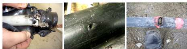
Рис. 2. Воздействие частичных разрядов на изоляцию
