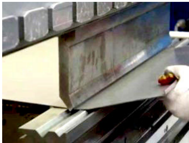
Рис. 1. Гибка листового металла на гидравлическом прессе
