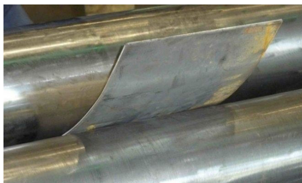
Рис. 2. Процесс вальцовки листового металла на вальцовочной машине с тремя роликми
