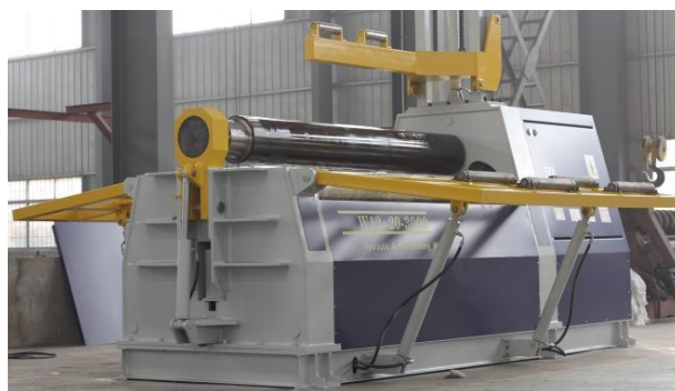
Рис. 1. Гидравлическая вальцовочная машина с ЧПУ для гибки листового металла
