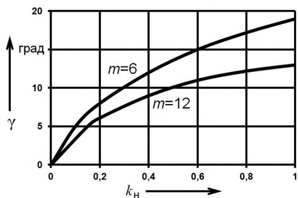
Рис. 5. Зависимость угла коммутации от коэффициента нагрузки
