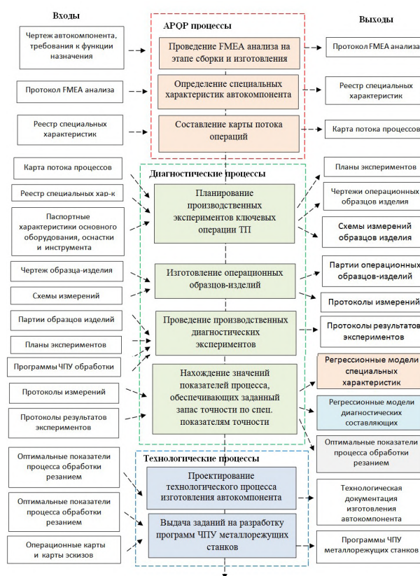
Рис. 2. Фрагмент последовательности процедур APQP процесса нового компонента на действующем производстве, обеспечивающий назначение оптимальных показателей процессов обработки резанием
