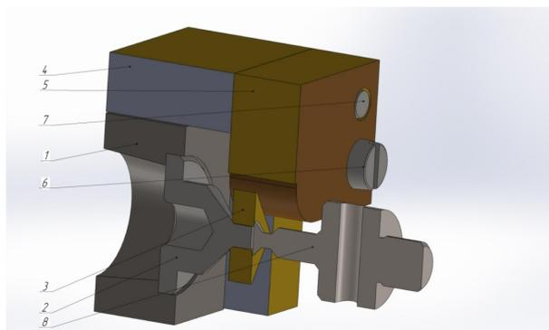
Рис. 5. Сборка крепления МТП на станке
