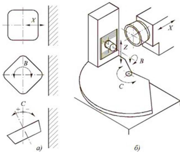
Рис. 1. Схема шлифования задних поверхностей МТП на станке с ЧПУ: а — главные формообразующие движения; б — данные движения на станке
