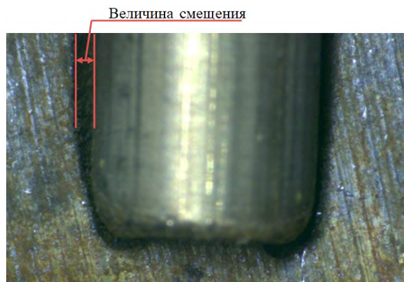
Рис. 3. Образование конусности в глухом отверстии
