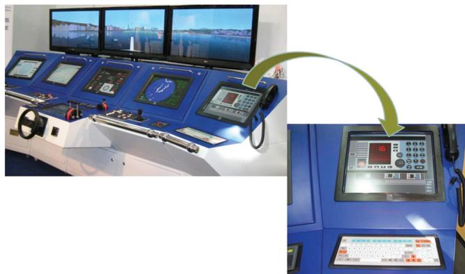
Рис. 2. Виртуальная панель управления оборудованием ГМССБ фирмы Thorne&amp;Thorne
