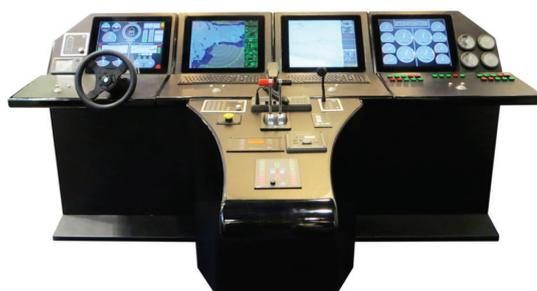
Рис. 3. Интегрированная мостиковая система
