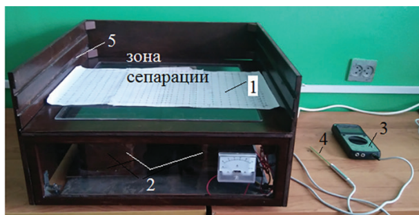
Рис. 2. Внешний вид испытательного стенда для исследования трехмерного магнитного поля макетного образца подвешенного ЭЖ:
