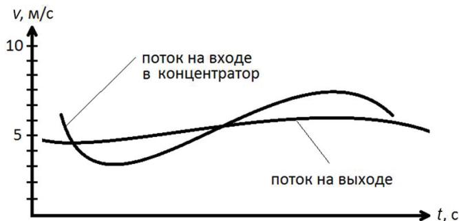
Рис. 3. Усредненные значения скорости воздушного потока на входе и на выходе из концентраторной установки
