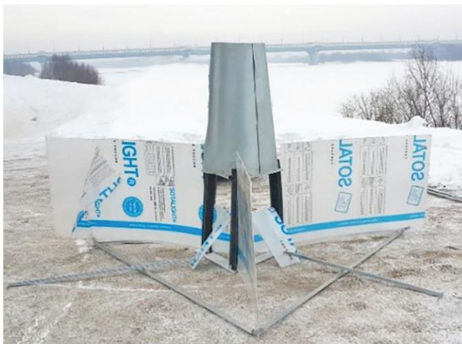
Рис. 4. Натурные испытания прототипа концентраторной ВЭУ со свободными лопастями в теле концентратора
