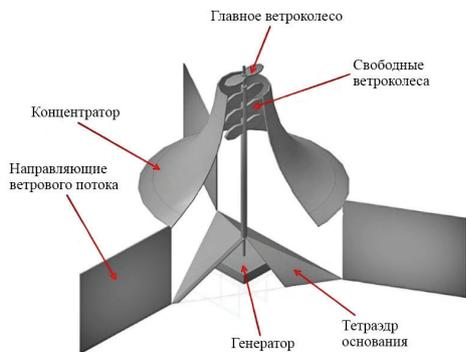
Рис. 2. Прототип концентраторной ВЭУ со свободными лопастями
