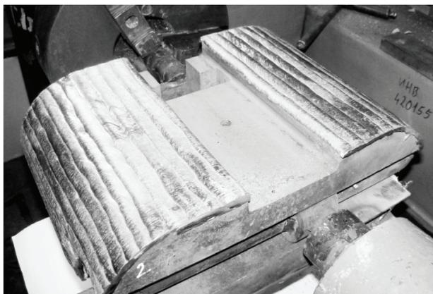
Рис. 6. Наплавленная плашка превентора
