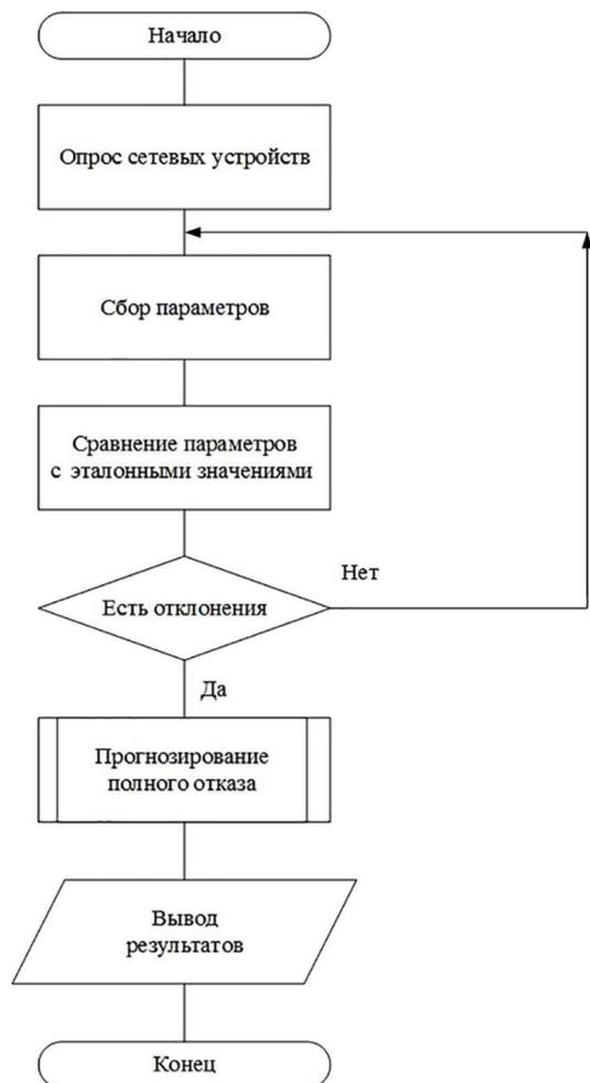
Рис. 1. Схема алгоритма мониторинга
