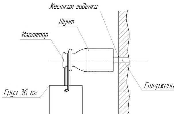
Рис. 4. Схема экспериментальной установки для проверки механической прочности
