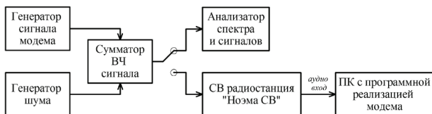
Рис. 8. Структура лабораторного стенда
