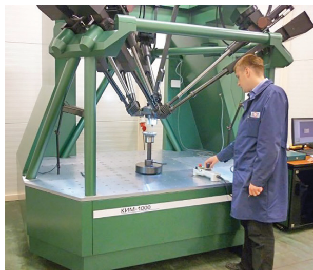
Рис. 2. Координатно-измерительная машина КИМ-1000 «Лапик»
